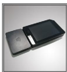
Antenne NFC frontale Badgeage face avant
